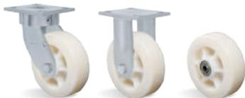
**RODA NT - Nylon Técnico. Dureza: 75 Shore D. (-40°C a +110°C).** Produzida com revestimento e núcleo em Poliamida 6 (Nylon) de alta qualidade. É leve e possui ótima resistência mecânica, roda com muita facilidade exigindo menor esforço para manobras e movimentação. Ideal para aplicações em ambientes úmidos, é resistente a graxas, óleos, sais e alguns tipos de ácidos. Fabricada com material reciclável. A velocidade de trabalho indicada é até 4 km/h.
