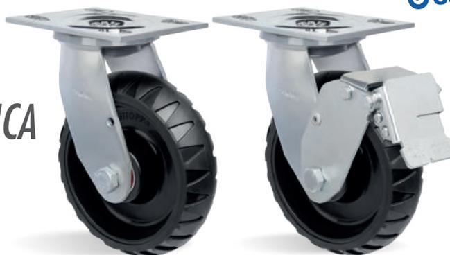
**RODA STR - Borracha Termoplástica. Dureza: 70 Shore A. (-20°C a +70°C).** Produzida com revestimento em borracha termoplástica e núcleo em polipropileno copolímero recicláveis. O perfil da banda de rodagem possui desenho em forma de estrias que permite maior aderência em pisos internos e externos. Proporciona rolagem macia e silenciosa, ótima proteção ao piso, excelente resistência química, boa resistência ao desgaste e impactos. A velocidade de trabalho indicada é até 4km/h.
