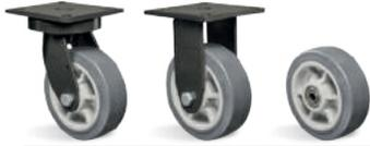
**RODA BP - Composto Termoplástico com PVC. Dureza: 85 Shore A. (-10°C a +50°C).** Produzida com revestimento em composto termoplástico com PVC e núcleo em polipropileno copolímero recicláveis. Proporciona rodamagem macia e silenciosa, ótima proteção ao piso, excelente resistência química, boa resistência ao desgaste e aos impactos, resultando em ótima relação custo/benefício. A velocidade de trabalho indicada é até 4km/h.
