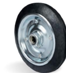
**PM - Borracha Maciça com Núcleo em Chapa Estampada. Dureza: 80 Shore A. (-20°C a +70°C).** Produzidas com aro de borracha maciça, com núcleo em chapas de aço carbono estampado, com acabamento zincado. São leves e resistentes, tem rodagem macia e silenciosa, e são indicadas para serviços leves em pisos em bom estado. A velocidade de trabalho indicada é até 4km/h.
