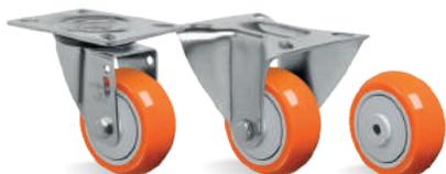
**RODA UP - Poliuretano Termoplástico. Dureza: 90 Shore A. (-20°C a +70°C).** Produzida com revestimento em poliuretano termoplástico elastollan e núcleo em polipropileno copolímero recicláveis. Ideal para quem procura excelente capacidade de carga aliada a uma ótima proteção do piso com baixo ruído no deslocamento, proporciona excelente resistência a abrasão e impactos. Resistente a graxas, óleos minerais e alguns ácidos. A velocidade de trabalho indicada é até 4 km/h.
