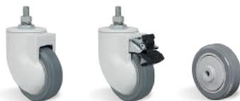
**RODA BP - Composto Termoplástico com PVC. Dureza: 85 Shore A. (-10°C a +50°C)**
