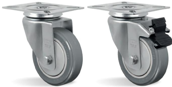
**RODA BP - Composto Termoplástico com PVC. Dureza: 85 Shore A. (-10°C a +50°C).** Produzida com revestimento em composto termoplástico com PVC e núcleo em polipropileno copolímero recicláveis. Proporciona rotação macia e silenciosa, ótima proteção ao piso, excelente resistência química, boa resistência ao desgaste e aos impactos, resultando em ótima relação custo/benefício. A velocidade de trabalho indicada é até 4km/h.
