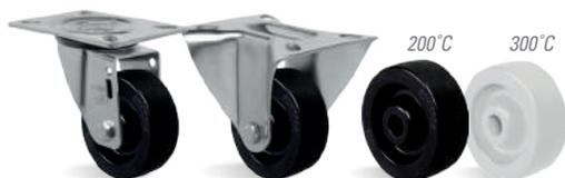
**RODA TM - Termic. Dureza: 90 Shore D. Preta (0°C a +200°C), Cinza (0°C a +300°C).** Fabricada com resina fenólica (baquelite), moldada sob alta pressão e calor. Indicada para aplicações em ambientes com temperaturas elevadas. Possui boas propriedades mecânicas, não deforma com carga estática e rola com facilidade. É resistente à maioria dos produtos químicos. A velocidade de trabalho indicada é até 4 km/h.
