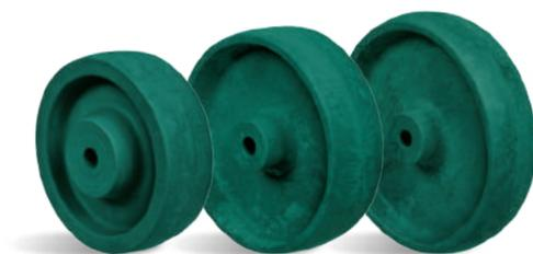
**NHT - Composto Termoplástico Reforçado com Fibra de Vidro. Dureza: 85 Shore D. (-20°C a +220°C).** Produzidas com composto termoplástico de engenharia, reforçado com fibra de vidro. Indicadas para aplicações em altas e baixas temperaturas. São leves, possuem ótima resistência mecânica, rodam com muita facilidade exigindo menor esforço para manobras e movimentação. São resistentes a graxas, óleos, sais e alguns tipos de ácidos. A velocidade de trabalho indicada é até 4km/h.
