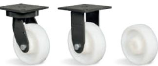
**RODA NTT - Nylon Técnico. Dureza: 75 Shore D. (-40°C a +110°C).** Produzida em injeção única com Poliamida 6 (Nylon) de alta qualidade. É leve, possui ótima resistência mecânica, roda com muita facilidade exigindo menor esforço para manobras e movimentação, não deforma sob carga estática. Ideal para aplicações em ambientes úmidos, é resistente a graxas, óleos, sais e alguns tipos de ácidos. Fabricada com material reciclável. A velocidade de trabalho indicada é até 4 km/h.
