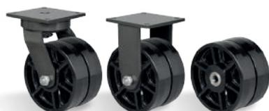
**RODA F - Ferro Fundido. Dureza: 160 Brinell. (-40°C a +400°C).** Produzida com ferro fundido cinzento, roda com muita facilidade e proporciona grande redução do esforço de movimentação. É muito resistente e suporta cargas e temperaturas elevadas. Não é indicada para a utilização quando o nível de ruídos e a conservação do piso são necessários. A velocidade de trabalho indicada é até 4 km/h.
