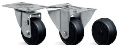
**RODA NPP - Polipropileno. Dureza: 65 Shore D. (-20°C a +70°C).** Produzida em injeção única com polipropileno copolímero reciclável. Indicada para cargas leves, roda com muita facilidade requerendo pouco esforço para movimentação, não deforma sob carga estática e possui ótima relação custo/benefício. Apresenta boa resistência química e a impactos moderados. A velocidade de trabalho indicada é até 4 km/h.
