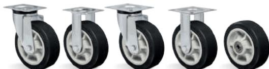
**RODA TP - Composto Termoplástico. Dureza: 85 Shore A. (-10°C a +50°C).** Produzida com revestimento em composto termoplástico e núcleo em polipropileno copolímero recicláveis. Proporciona rodamagem macia e silenciosa, ótima proteção ao piso, excelente resistência química, boa resistência ao desgaste e impactos, resultando em ótima relação custo/benefício. A velocidade de trabalho indicada é até 4km/h.
