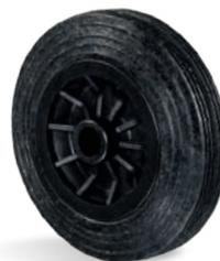
**PMN - Borracha Maciça com Núcleo de Polipropileno. Dureza: 80 Shore A. (-20°C a +70°C).** Fabricadas com aro de borracha maciça e núcleo de polipropileno. Indicadas para aplicações em pisos irregulares onde é necessário facilidade de movimentação, amortecimento a impactos e vibrações. A velocidade de trabalho indicada é até 4km/h.
