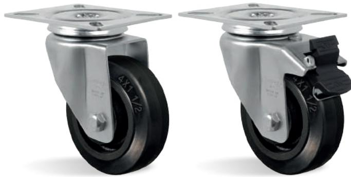
**RODA B - Borracha Moldada. Dureza: 80 Shore A. (-20°C a +70°C).** Produzida com revestimento de borracha moldada vulcanizada em núcleo de ferro fundido cinzento. Roda com suavidade e baixo nível de ruídos, absorve choques e vibrações. É resistente a abrasão e produtos químicos. Pode ser utilizada em velocidades de até 4km/h.
