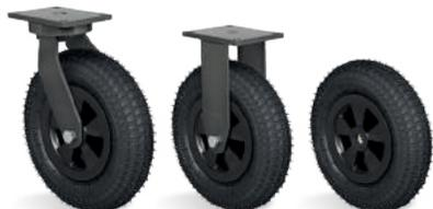
**RODA PP - Pneumática - Núcleo de Nylon. (-20°C a +50°C).** Fabricada com pneu e câmara de ar e núcleo injetados em nylon. Indicada para aplicações em pisos irregulares onde é necessária facilidade de movimentação e amortecimento dos impactos e vibrações. Proporciona fácil manutenção, e seus componentes podem ser fornecidos separadamente. A velocidade de trabalho indicada é até 4 km/h.
