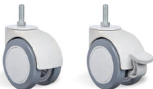
**RODA BP - Composto Termoplástico com PVC. Dureza: 85 Shore A. (-10°C a +50°C)**
