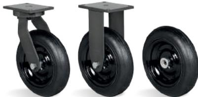
**RODA PM - Borracha (Aro). Dureza: 80 Shore A. (-20°C a +70°C).** Produzida com aro de borracha maciça e flanges (núcleo) em chapas de aço carbono estampadas. Não necessita de manutenção, não fura, rola com facilidade sob obstáculos, e é indicada para uso em pisos irregulares. As flanges são presas por parafusos que facilitam a montagem e reposição dos seus componentes, que podem ser fornecidos separadamente. A velocidade de trabalho indicada é até 4km/h.
