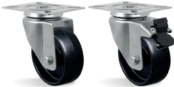
**RODA NPP - Polipropileno.** Dureza: 65 Shore D. (-20°C a +70°C). Produzida em injeção única com polipropileno copolímero reciclável. Indicada para cargas leves, roda com muita facilidade requerendo pouco esforço para movimentação, não deforma sob carga estática e possui ótima relação custo/benefício. Apresenta boa resistência química e a impactos moderados. A velocidade de trabalho indicada é até 4 km/h.
