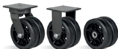
**RODA B - Borracha Moldada. Dureza: 80 Shore A. (-20°C a +70°C).** Produzida com revestimento de borracha moldada vulcanizada em núcleo de ferro fundido cinzento. Roda com suavidade e baixo nível de ruídos, absorve choques e vibrações. É resistente à abrasão e produtos químicos. Pode ser utilizada em velocidades de até 20km/h quando montada com rolamento de esferas.
