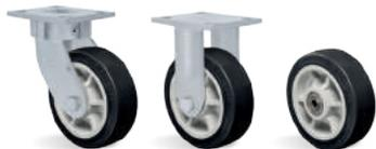
**RODATP - Composto Termoplástico. Dureza: 85 Shore A. (-10°C a +50°C).** Produzida com revestimento em composto termoplástico e núcleo em polipropileno copolímero recicláveis. Proporciona rodamem macia e silenciosa, ótima proteção ao piso, excelente resistência química, boa resistência ao desgaste e impactos, resultando em ótima relação custo/benefício. A velocidade de trabalho indicada é até 4km/h.
