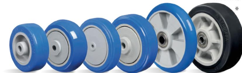
**TP - Composto Termoplástico. Dureza: 85 Shore A. (-10°C a +50°C).** Produzidas com revestimento em composto termoplástico e núcleo em polipropileno copolímero recicláveis. Proporcionam rodagem macia e silenciosa, ótima proteção ao piso, excelente resistência química, boa resistência ao desgaste e impactos, resultando em ótima relação custo/benefício. A velocidade de trabalho indicada é até 4km/h.
