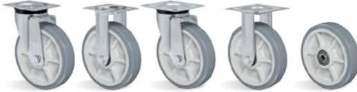
**RODA BP - Composto Termoplástico com PVC. Dureza: 85 Shore A. (-10°C a +50°C).** Produzida com revestimento em composto termoplástico com PVC e núcleo em polipropileno copolímero recicláveis. Proporciona rodagem macia e silenciosa, ótima proteção ao piso, excelente resistência química, boa resistência ao desgaste e aos impactos, resultando em ótima relação custo/benefício. A velocidade de trabalho indicada é até 4km/h.
