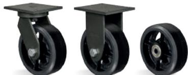
**RODA B - Borracha Moldada. Dureza: 80 Shore A. (-20°C a +70°C).** Produzida com revestimento de borracha moldada vulcanizada em núcleo de ferro fundido cinzento. Roda com suavidade e baixo nível de ruídos, absorve choques e vibrações. É resistente à abrasão e produtos químicos. Fornecida com graxeira para lubrificação quando montada com rolamento de roletes ou sob solicitação. Pode ser utilizada em velocidades de até 20km/h.
