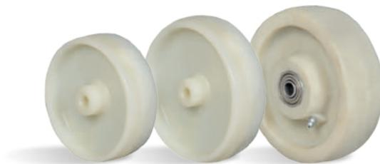
NFV - Nylon Reforçado com Fibra de Vidro. Dureza: 80 Shore D. (-40°C a +180°C). Produzidas com Poliamida 6.6 (Nylon) reforçado com fibra de vidro. Indicadas para aplicações em altas e baixas temperaturas. São leves, possuem ótima resistência mecânica, rodam com muita facilidade exigindo menor esforço para manobras e movimentação. São resistentes a graxas, óleos, sais e alguns tipos de ácidos. A velocidade de trabalho indicada é até 4km/h.
