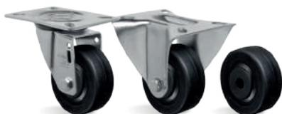
**RODA BIN – Borracha Moldada – Núcleo de Ebonite. Dureza: 80 Shore A. (-20°C a +70°C).** Produzida com revestimento de borracha moldada vulcanizada em núcleo de ebonite. É leve, roda com suavidade e baixo nível de ruídos, absorve choques e vibrações, e não oxida. É muito resistente à abrasão e a produtos químicos. A velocidade de trabalho indicada é até 4 km/h.
