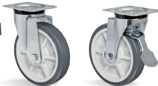
**RODA TB - Borracha Termoplástica. Dureza: 80 Shore A. (-20°C a +70°C).** Produzida com revestimento em borracha termoplástica e núcleo em polipropileno copolímero recicláveis. Apresenta excelente proteção ao piso, rodamem macia e silenciosa, facilidade para movimentação e manobras, resiste a impactos, possui baixa deformação sob carga e excelente resistência a abrasão. Possui boa resistência a intempéries e a agentes químicos como sais e graxas. A velocidade de trabalho indicada é até 4km/h.
