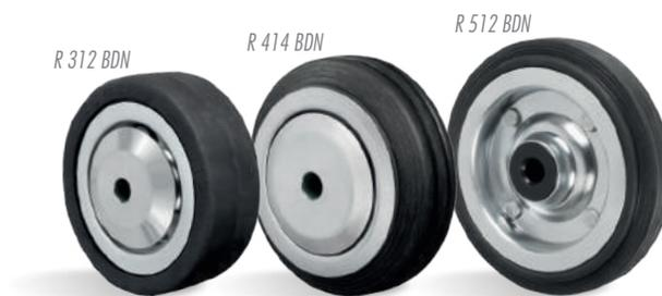
**BD - Borracha Maciça com Núcleo em Chapa Estampada. Dureza: 80 Shore A. (-20°C a +70°C).** Produzidas com aro de borracha maciça, com núcleo em chapas de aço carbono estampado, com acabamento zincado. São leves e resistentes, tem rodagem macia e silenciosa, e são indicadas para serviços leves em pisos em bom estado. A velocidade de trabalho indicada é até 4km/h.
