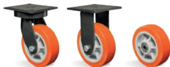
**RODA UP - Poliuretano Termoplástico. Dureza: 90 Shore A. (-20°C a +70°C).** Produzida com revestimento em poliuretano termoplástico elastollan e núcleo em polipropileno copolímero recicláveis. Ideal para quem procura excelente capacidade de carga aliada a uma ótima proteção do piso com baixo ruído no deslocamento, proporciona excelente resistência à abrasão e impactos. Resistente a graxas, óleos minerais e alguns ácidos. A velocidade de trabalho indicada é até 4 km/h.
