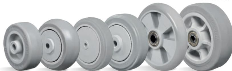
SP - Borracha Termoplástica Extra Macia. Dureza: 65 Shore A. (-10°C a +50°C). Rodas injetadas com revestimento em borracha termoplástica extra macia e núcleo em polipropileno copolímero recicláveis. Suas vantagens são o baixíssimo nível de ruído no deslocamento e a redução de vibrações. Indicadas para movimentações de cargas leves, proporcionam excelente proteção ao piso, resistência regular a impactos e boa resistência a meios químicos. A velocidade de trabalho indicada é até 4km/h.
