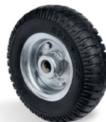
PM - Borracha Maciça com Núcleo de Chapa Estampada. Dureza: 80 Shore A. (-20°C a +70°C). Produzidas com aro de borracha maciço, com núcleo em chapa estampada com acabamento zincado. São leves e resistentes, tem rodagem macia e silenciosa, e são indicadas para serviços leves em pisos em bom estado. A velocidade de trabalho indicada é até 4km/h.
