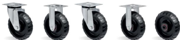
**RODA STR - Borracha Termoplástica. Dureza: 70 Shore A. (-20°C a +70°C).** Produzida com revestimento em borracha termoplástica e núcleo em polipropileno copolímero recicláveis. O perfil da banda de rodagem possui desenho em forma de estrias que permite maior aderência em piso externos e internos. Proporciona rodamgem macia e silenciosa, ótima proteção ao piso, excelente resistência química, boa resistência ao desgaste e impactos. A velocidade de trabalho indicada é até 4km/h.
