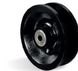
V - Grooved - Ferro com Canal em V. Dureza: 160 Brinell. (-40°C a +400°C). Produzidas com ferro fundido cinzento, possuem canal em “V” na banda de rodagem. Projetadas para montagem sobre cantoneiras, rodam com facilidade e proporcionam grande redução do esforço de movimentação. São muito resistentes e suportam cargas e temperaturas elevadas.
