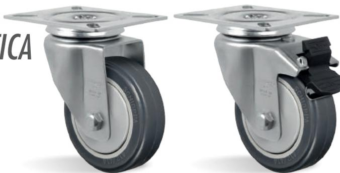
**RODA TB - Borracha Termoplástica. Dureza: 80 Shore A. (-20°C a +70°C).** Produzida com revestimento em borracha termoplástica e núcleo em polipropileno copolímero recicláveis. Apresenta excelente proteção ao piso, rodagem macia e silenciosa, facilidade para movimentação e manobras, resiste a impactos, possui baixa deformação sob carga e excelente resistência a abrasão. Possui boa resistência a intempéries e a agentes químicos como sais e graxas. A velocidade de trabalho indicada é até 4km/h.
