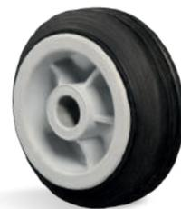
**BMN - Borracha Maciça com Núcleo de Polipropileno. Dureza: 80 Shore A. (-20°C a +70°C).** Produzida com aro de borracha maciça, com núcleo em polipropileno injetado. É leve e resistente, suporta umidade, tem rodagem macia e silenciosa, e é indicada para serviços leves em pisos em bom estado. A velocidade de trabalho indicada é até 4 km/h.
