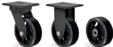
**RODA B - Borracha Moldada. Dureza: 80 Shore A. (-20°C a +70°C).** Produzida com revestimento de borracha moldada vulcanizada em núcleo de ferro fundido cinzento. Roda com suavidade e baixo nível de ruídos, absorve choques e vibrações. É resistente à abrasão e produtos químicos. Fornecida com graxeira para lubrificação quando montada com rolamento de roletes ou sob solicitação. Pode ser utilizada em velocidades de até 20 km/h quando montada com rolamentos de esferas.
