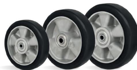
**ALBS - Borracha Moldada com Camada Dupla. Dureza: 80 Shore A. (-20°C a +70°C).** Produzidas com revestimento de borracha moldada com camada dupla vulcanizada em núcleo de alumínio. Proporciona grande absorção de choques e vibrações, alta resistência a abrasão, e maior vida útil devido sua camada de borracha de maior espessura. Resiste a corrosão e a produtos químicos. A velocidade de trabalho indicada é até 16km/h.
