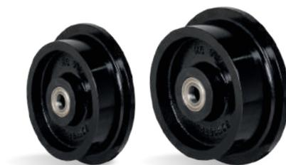
DV - Decauville - Ferro para Trilho. Dureza: 160 Brinell. (-40°C a +400°C). Produzidas com ferro fundido cinzento, possui uma aba na lateral da banda de rodagem. Projetadas para montagens sobre trilhos ou vigas. Rodam com muita facilidade e proporcionam grande redução do esforço de movimentação. São muito resistentes e suportam cargas e temperaturas elevadas.
