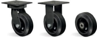
**RODA B - Borracha Moldada. Dureza: 80 Shore A. (-20°C a +70°C).** Produzida com revestimento de borracha moldada vulcanizada em núcleo de ferro fundido cinzento. Roda com suavidade e baixo nível de ruídos, absorve choques e vibrações. É resistente à abrasão e produtos químicos. Fornecida com graxeira para lubrificação quando montada com rolamento de roletes ou sob solicitação. Pode ser utilizada em velocidades de até 20km/h quando montada com rolamentos de esferas.
