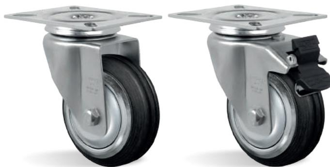
**RODA BD - Borracha Maciça com Núcleo em Chapa Estampada. Dureza: 80 Shore A. (-20°C a +70°C).** Produzida com aro de borracha maciça, com núcleo em chapas de aço carbono estampado, com acabamento zincado. É leve e resistente, tem rodagem macia e silenciosa, e é indicada para serviços leves em pisos em bom estado. A velocidade de trabalho indicada é até 4 km/h.
