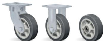
**RODA TB - Borracha Termoplástica. Dureza: 80 Shore A. (-20°C a +70°C).** Produzida com revestimento em borracha termoplástica e núcleo em polipropileno copolímero recicláveis. Apresenta excelente proteção ao piso, rodamem macia e silenciosa, facilidade para movimentação e manobras, resiste a impactos, possui baixa deformação sob carga e excelente resistência à abrasão. Possui boa resistência a intempéries e a agentes químicos como sais e graxas. A velocidade de trabalho indicada é até 4km/h.
