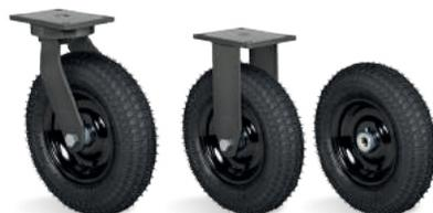
**RODA PC - Pneumática - Núcleo de Chapa Estampada. (-20°C a +50°C).** Fabricada com pneu e câmara de ar, com flanges (núcleo) em chapas de aço carbono estampado e acabamento pintado. Indicada para aplicações em pisos irregulares onde é necessária facilidade de movimentação e amortecimento dos impactos e vibrações. Proporciona fácil manutenção e seus componentes pode ser fornecidos separadamente. A velocidade de trabalho indicada é até 4km/h.
