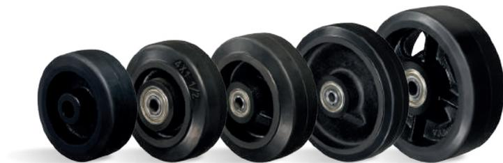
**B - Borracha Moldada. Dureza: 80 Shore A. (-20°C a +70°C).** Produzidas com revestimento de borracha moldada vulcanizada em núcleo de ferro fundido cinzento. Rodam com suavidade e baixo nível de ruídos, absorvem choques e vibrações. São resistentes a abrasão e produtos químicos. A velocidade de trabalho indicada é de até 20km/h, quando montadas com rolamentos de esferas e garfos apropriados.
