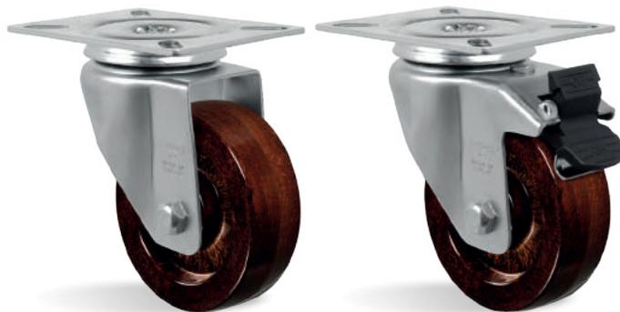
Garfo fabricado em chapa estampada e cabeçote com dupla pista de esferas, acabamento zincado. Eixo da roda parafusado.
