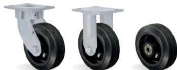
**RODA B - Borracha Moldada. Dureza: 80 Shore A. (-20°C a +70°C).** Produzida com revestimento de borracha moldada vulcanizada em núcleo de ferro fundido cinzento. Roda com suavidade e baixo nível de ruídos, absorve choques e vibrações. É resistente à abrasão e produtos químicos. Fornecida com graxeira para lubrificação quando montada com rolamento de roletes ou sob solicitação. Pode ser utilizada em velocidades de até 20km/h quando montada com rolamentos de esferas.
