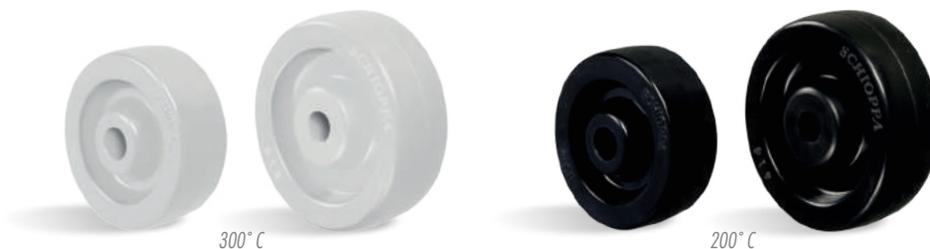
TM - Termic. Dureza: 90 Shore D. Preta (0°C a +200°C), Cinza (0°C a +300°C). Fabricadas com resina fenólica (baquelite), moldadas sob alta pressão e calor. Indicadas para aplicações em ambientes com temperaturas elevadas. Possuem boas propriedades mecânicas, não deformam com carga estática, e rodam com facilidade. São resistentes a maioria dos produtos químicos. A velocidade de trabalho indicada é até 4km/h.
