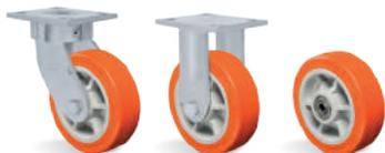
**RODA UP - Poliuretano Termoplástico. Dureza: 90 Shore A. (-20°C a +70°C).** Produzida com revestimento em poliuretano termoplástico elastollan e núcleo em polipropileno copolímero recicláveis. Ideal para quem procura excelente capacidade de carga aliada a uma ótima proteção do piso com baixo ruído no deslocamento, proporciona excelente resistência à abrasão e impactos. Resistente a graxas, óleos minerais e alguns ácidos. A velocidade de trabalho indicada é até 4 km/h.
